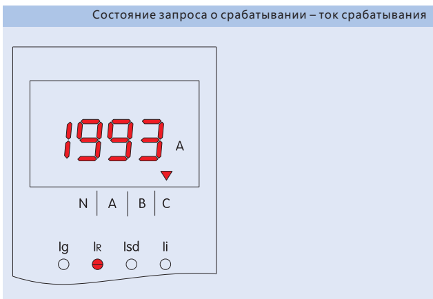
Состояние запроса о срабатывании – ток срабатывания
