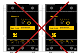
Монтировать приборы вплотную запрещено!
