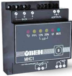
Д DIN-реечный 72×90×52 мм IP20
