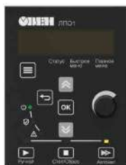
ЛПО1 (для ПЧВ1, ПЧВ2 с потенциометром, IP20)
