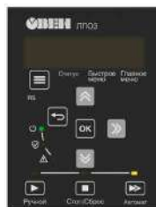
ЛПО3 (для ПЧВ3 без потенциометра, IP54)
