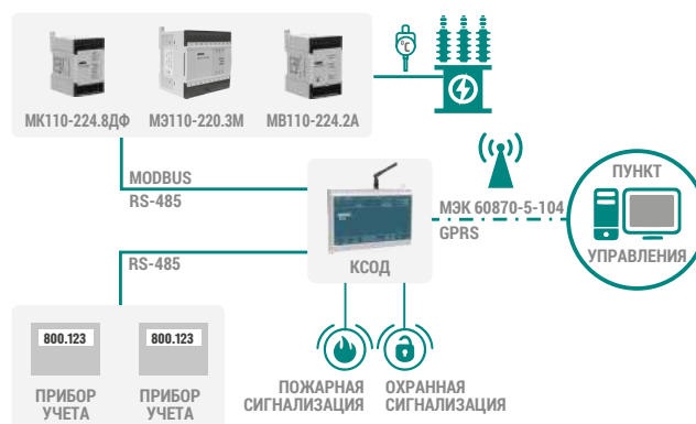
Система телемеханики трансформаторной подстанции 6(10)/0,4 кВ
